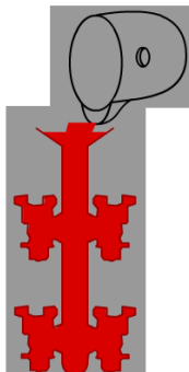
Etape 7 : Coulée du métal en fusion dans le moule
