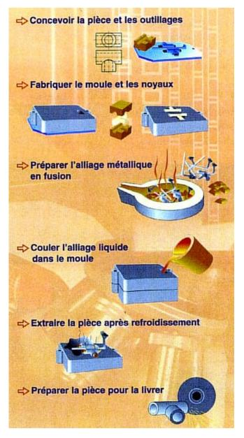
Le parachèvement comprend une suite d'opérations de finition des pièces, dont l'élimination du sable du moule et des noyaux, suivie selon les cas du grenaillage, du traitement thermique, de l'usinage, de la peinture ou des traitements de surface.
