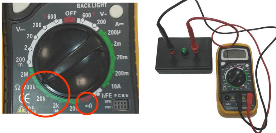
2.3 Appuyer sur le bouton poussoir. Noter les valeurs lues sur le multimètre en position appuyée ou relâchée :
