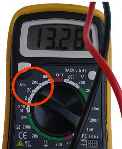
1.3 Régler le testeur sur le calibre 20V Continu
