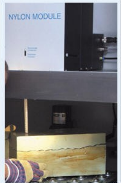
Chargement du moule silicone. Ce procédé se satisfait des moules silicones standards.
