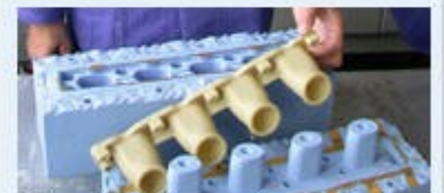
La fonction PLC, en remplacement de la coulée classique, permet un démoulage en seulement 6 minutes!
