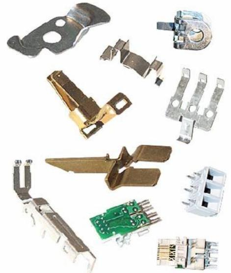
La plupart du temps, le découpage accompagne une opération de formage comme l'emboutissage ou le pliage. Dans certains cas, c'est la seule ou la principale opération réalisée (cas des rondelles ou des pièces plates de connectique).
